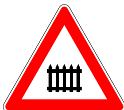
Bahnübergang mit Schranken oder Halbschranken
